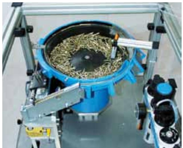
Die Blindniete werden mittels Versorgungsschlauch vom Schwingförderer zum Nietsetzkopf transportiert
