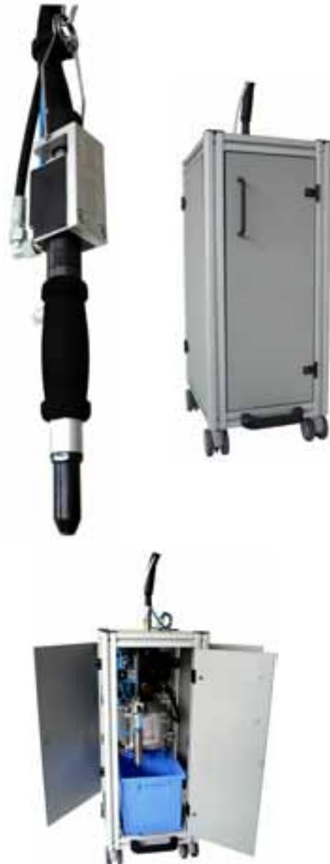
Die Versorgungseinheit mit Druckübersetzer, Pneumatiksteuerung und Restdorn-Sammelbehälter.
